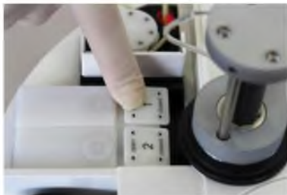
Рис. 5 – Открытие фиксатора сенсора
