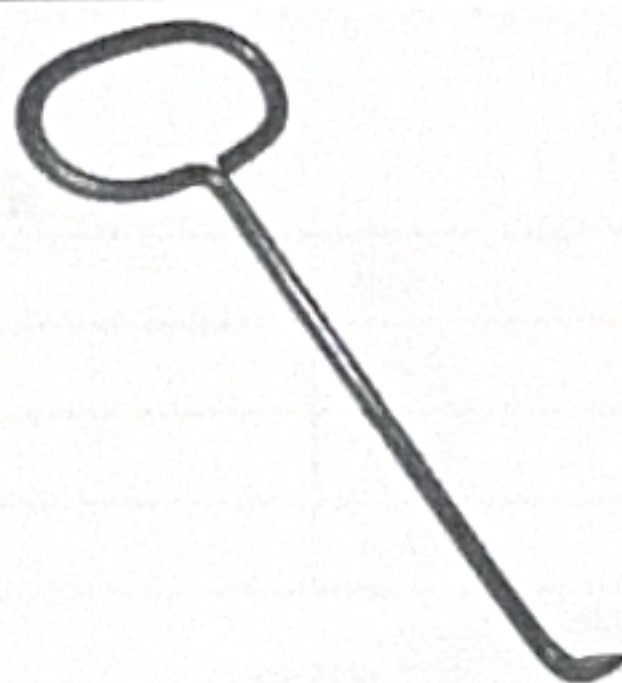
Рисунок. Внешний вид крюка для открывания крышек пожарных гидрантов
